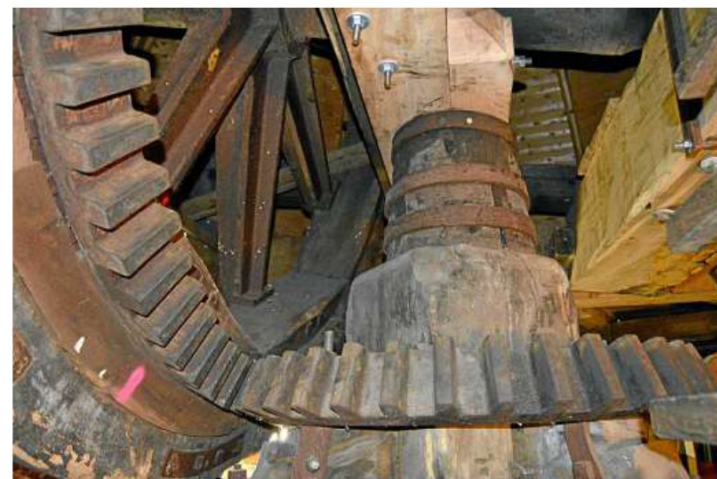
Das Oberlager (oben Mitte) der senkrecht durch den Mühlenkörper verlaufenden Königswelle wurde 2021 erneuert. Über das Kammrad (links) der Flügelwelle wird die Windkraft über das Zahnrad „Bunkler“ (unten) auf die Königswelle, über die die Mühlentechnik angetrieben wird, übertragen.
